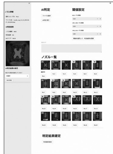
図 3 吸着ノズル検査 AI 判定ソフトウェアの画面 [沖電気工業(株)]
